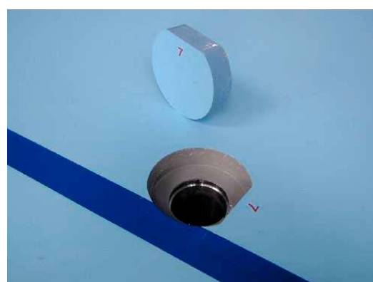
..couvercles durs (non conformes)
